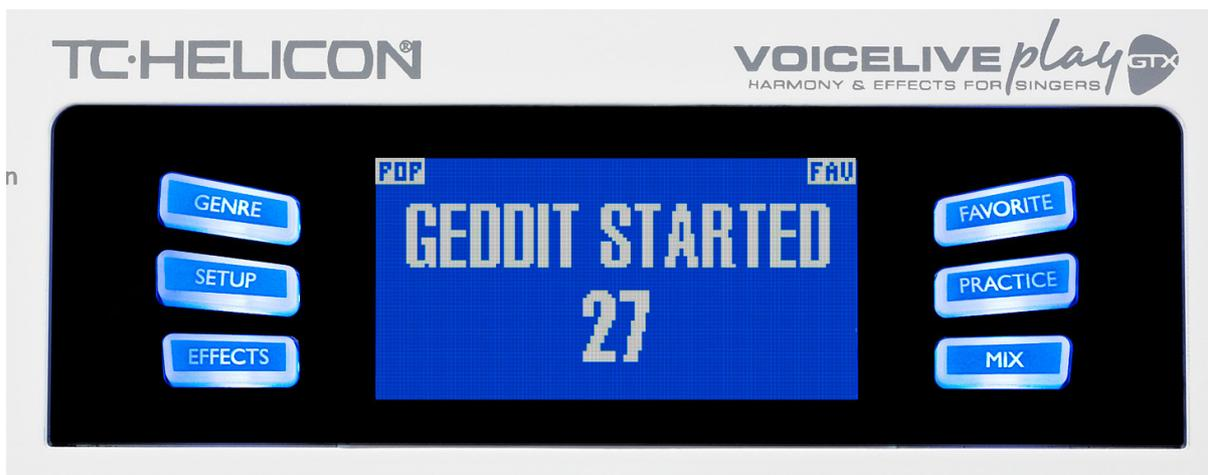
Доступно 6 “экранных” кнопок, по 3 с каждой стороны дисплея. На каждую кнопку назначена своя функция. Если функция доступна, кнопка подсвечивается белым или синим цветом, если нет, то кнопка не горит. Если подсветка белая, функция соответствует нанесенному на кнопку тексту, если синяя, кнопка служит для выбора соответствующей области дисплея. В разных меню используется разное количество экранных кнопок.
