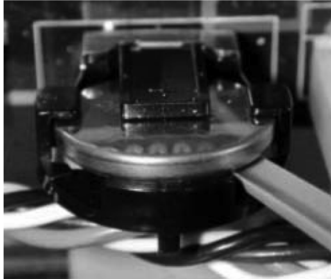
Рис. А-1. Освобождение батарейки от фиксирующего зажима
