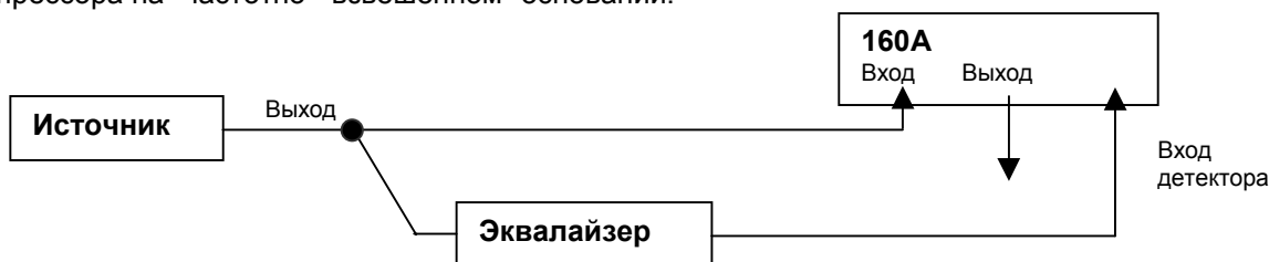
Фиг. 4: Частотно – зависимая компрессия
