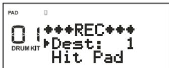
1. Нажмите кнопку REC, и DM-5S/DM-5 перейдет в режим записи-ожидания.
