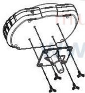
2. Установите DM-5S/DM-5 (с присоединенной к звуковому модулю монтажной пластиной) в стойку.
