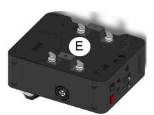
Для поперечной установки на основании корпуса расположены четыре резьбовых соединения (рис. D), к которым крепится крепежный элемент. (Рис. E, входит в комплект поставки).
