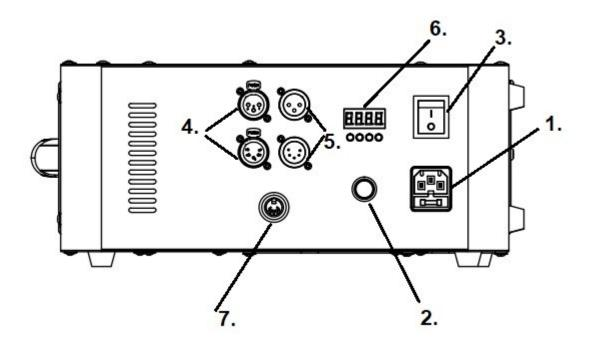
1. POWER IN: входной разъем питания IEC переменного тока с предохранителем F8A 250V.
