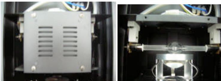
1. Открутите четыре винта на крышке прибора
