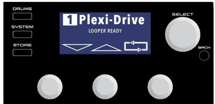
Ножные переключатели могут работать в 3 режимах – режим пресетов (Preset Mode), режим педалей (Stomp Mode) и режим банков (Bank Mode). Подробности в разделе “Режимы работы ножных переключателей (Footswitch mode)”. Регуляторы EDIT1 и EDIT3, в режиме Performance, управляют громкостью активного пресета (Preset Level) и общей громкостью (Master Level) процессора. Подробности в разделе “Громкость пресета и общая громкость”.
