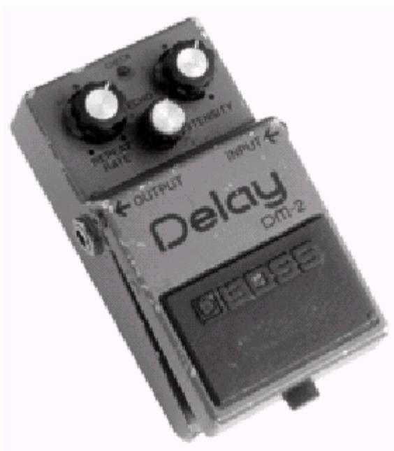
Устройства аналогового эхо, подобные DM-2 были сконструированы как улучшения кассетного эхо, используя для этого электроники типа пожарной цепочки для того, чтобы дать гитаристам устройств эхо, которые были бы более реальными чем основанные на кассетной задержке с дополнительными схемами низкого напряжения, которые могут работать на батарейках.
