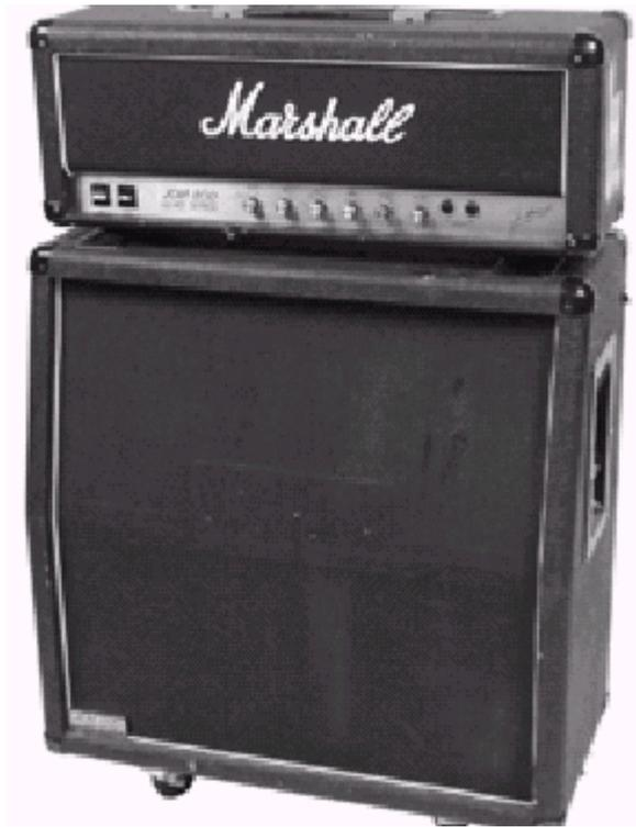
Выберите эту модель усилителя для вызова звуков JCM 800, одного из наиболее распространенных современных усилителей. Эта обновленная версия Plexi, продолжающая наследие Marshall с добавленным усилением и срезом для нового поколения рок гитаристов. Самая большая разница заключается в том, что регуляторы тембра расположены после лампового предусилителя.
