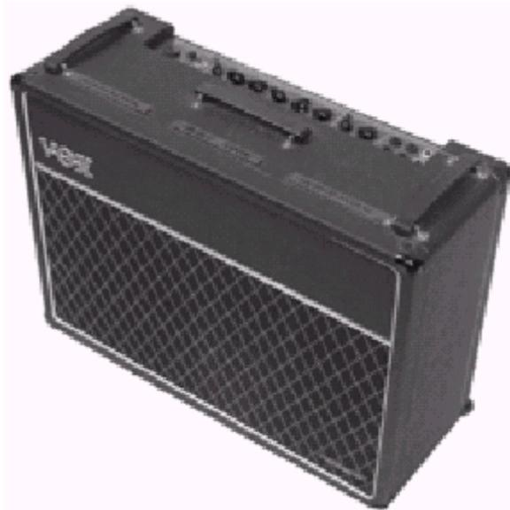
Музыка была изменена в начале 60-х а гитаристы требовали более яркого и резкого звучания. Таким образом, компания Jennings, создатели усилителей Vox, решили добавить регуляторы Treble и Bass (и между прочим дополнительную ступень усиления 12AX7) в дополнение к уже имеющейся ручке Обрезания Высоких (Treble Cut); эта дополнительная схема получила название Top Boost.
