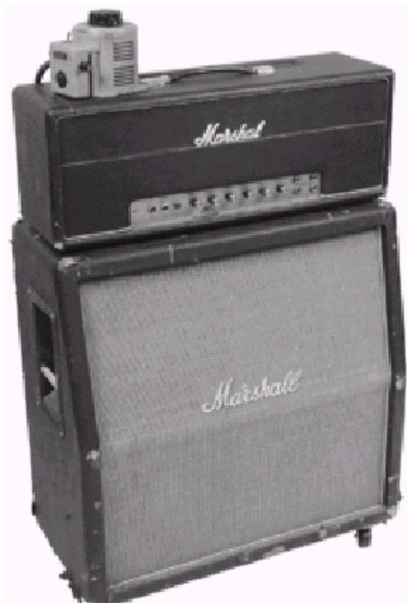
Перед вами легендарная вещь. Согласно истории, частью магии, стоящей за Edward Van Halen's 'Brown Sound' был 100 ваттный Marshall Super Lead умышленно запущенный на более высоком напряжении через защиту регулируемого автотрансформатора (так называемый Вариак).
