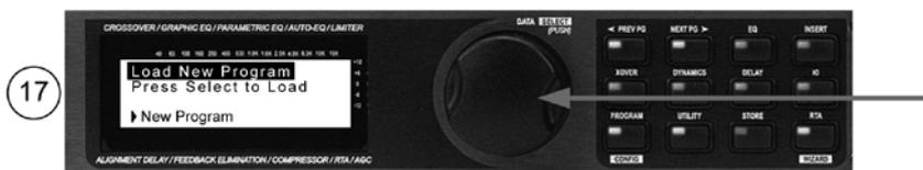
Нажмите на колесо, чтобы загрузить новую созданную программу.
