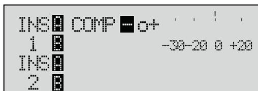
Здесь отображаются измерители степени редакции каждого из модулей Dynamic, установленного в разрыв Insert 1 или Insert 2.
