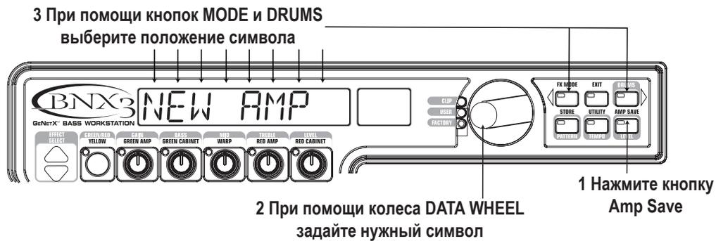
4. Когда на дисплее загорится VNTGASH, нажмите кнопку **AMP SAVE** еще раз. При помощи колеса **DATA WHEEL** выберите один из слотов пользовательских гипермоделей. На буквенно-цифровом дисплее должна гореть надпись EMPTY, а на красном цифровом дисплее должно быть написано U1, если это первая гипермодель, сохраняемая на вашем процессоре BNX3.
