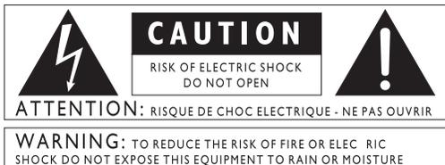
Символы, изображенные выше, являются общепринятыми знаками для предупреждения о возможной опасности электроприборов. Знак молнии в равностороннем треугольнике означает, что в устройстве присутствует опасное напряжение. Восклицательный знак в равностороннем треугольнике означает, что перед использованием устройства необходимо ознакомиться с руководством пользователя.
