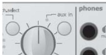
Кнопка AUX позволяет прослушивать сигнал на входах AUX (задняя панель). Это идеальная функция для прослушивания, скажем, клавишных через входы AUX.
