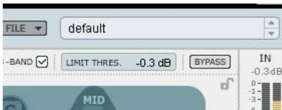
В Fabrik C также имеется лимитер (Limiter). Он используется для предотвращения перегрузок – пиков сигнала, не подавляемых компрессором. Лимитер используется для подавления пиков, а компрессор – для выравнивания общего уровня.
