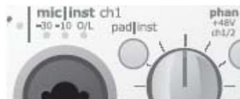
Подключение конденсаторного микрофона.
