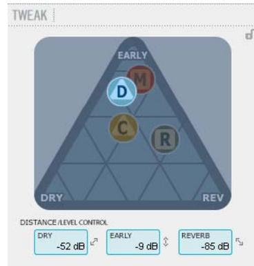
Соотношение уровней Dry, Early и Reverb определяет расстояние до источника звука. Чем меньше прямого (dry) сигнала, тем больше расстояние. Уровни Early и Reverb устанавливают взаимоотношения между отражениями и диффузным полем реверберации. Если нажата кнопка Kill Dry, уровень Dry Level зафиксирован на нуле. Если нажата кнопка Kill Wet, на нуле зафиксированы уровни Early и Reverb Levels.
