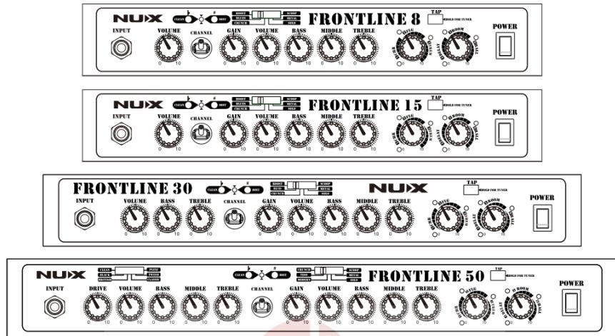
ВХОД / INPUT – гнездо подключения электрогитары
