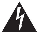
Символ молнии со стрелочкой в равнобедренном треугольнике предупреждает пользователя о наличии неизолированного высокого напряжения в устройстве. Это может стать причиной удара током.
