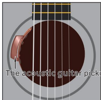
Схема сборки звукоснимателя акустической гитары
